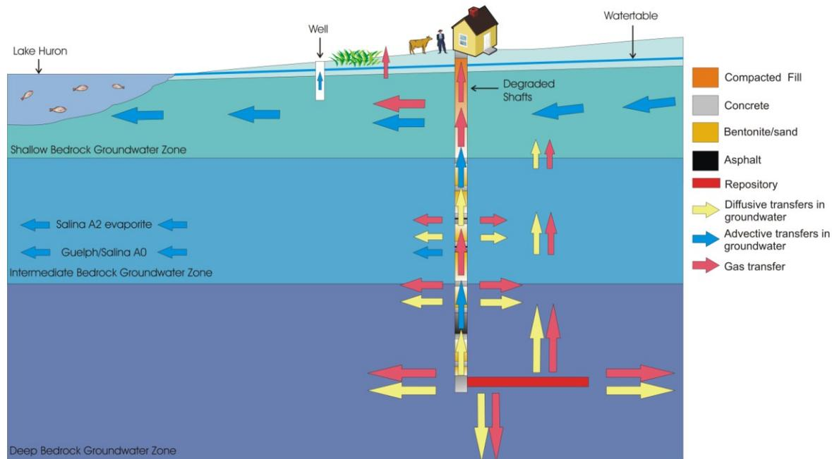
**Figure 3-1: Severe Shaft Seal Failure Scenario**
